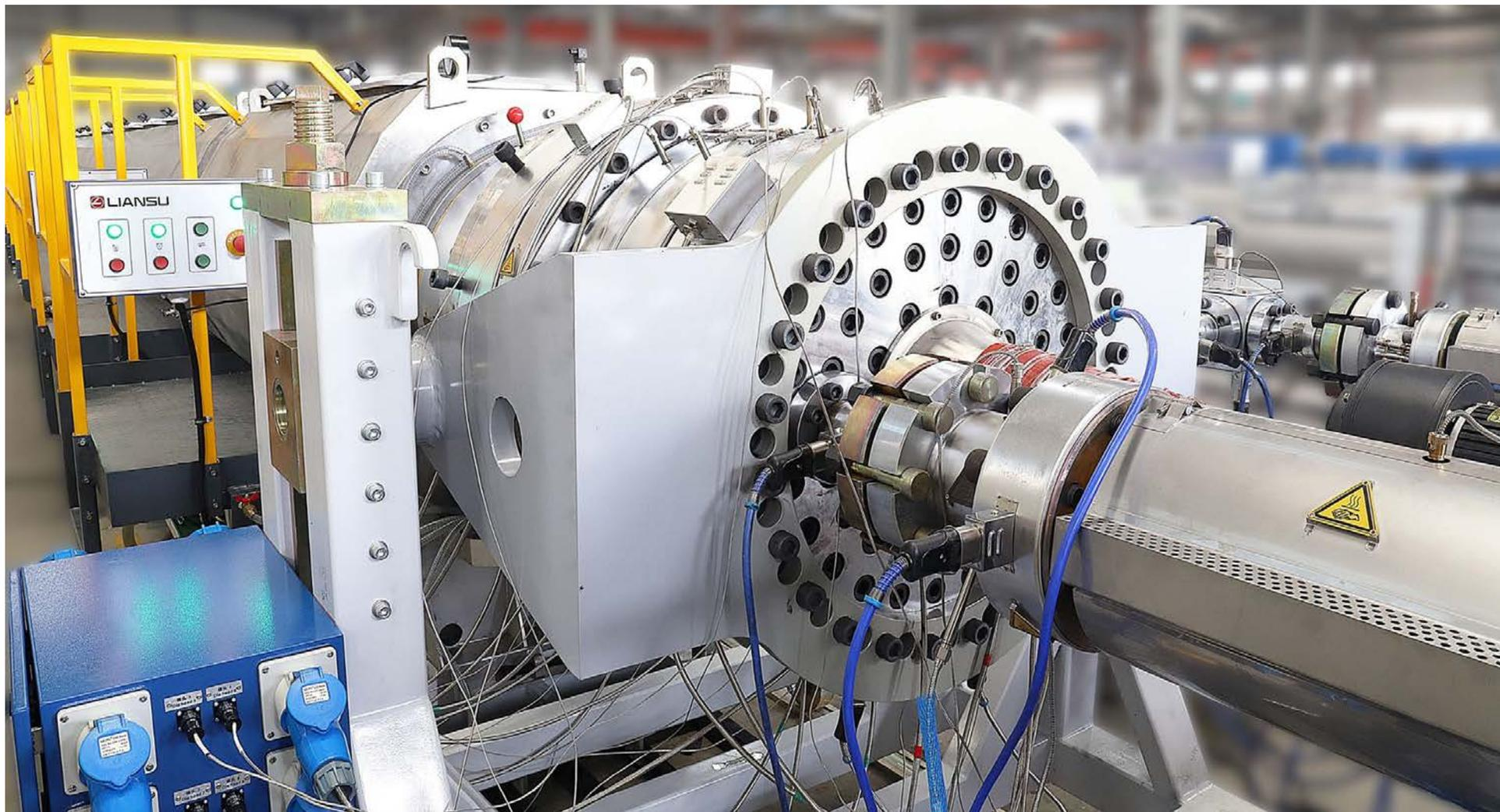
Три спиральные головки, обеспечивают равномерную толщину каждого слоя
